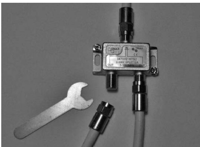
Rigtig antenneinstallation udføres med F-Connectorer
